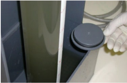
Figure 79 : Bouchage de la colonne
