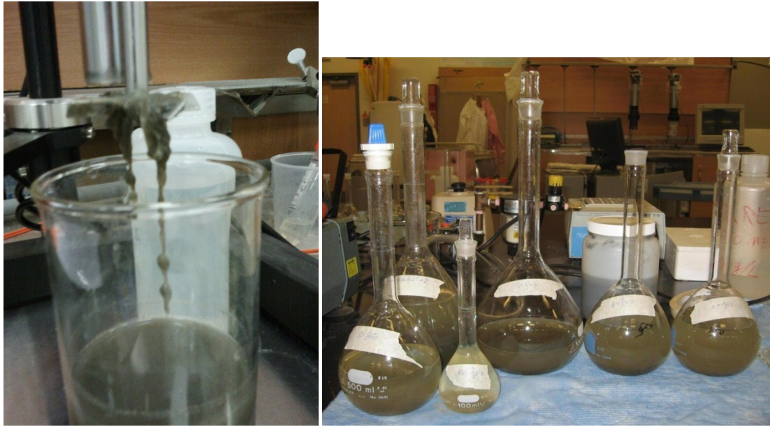
Figure 32: FBRM, tamisage de l'échantillon et série de dilution
