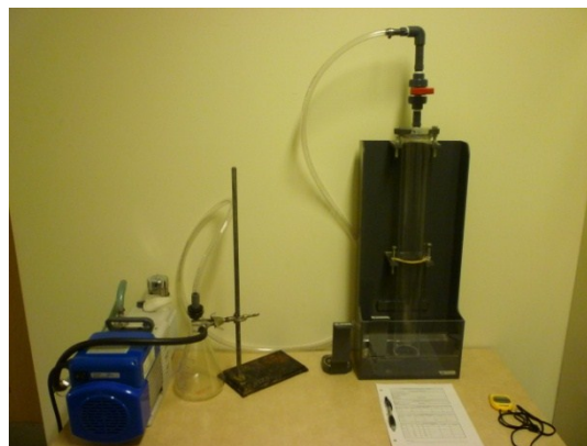
Figure 73 : Matériel ViCAs avec système de remplissage
