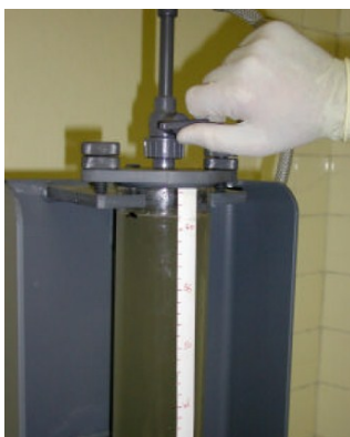
Figure 76 : Fermeture de la vanne \frac{1}{4} de tour
