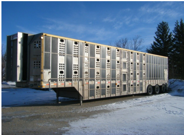
Figure 1.7 Remorque à « bedaine » avec 3 essieux, ventilation naturelle à moitié fermée à l'avant et fermée à l'arrière (photo prise par S. Goumon, avec la courtoisie de Steves Inc, MB, Canada)
