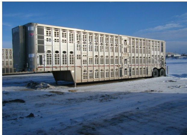
Figure 1.8 Remorque à « bedaine » avec 2 essieux, ventilation naturelle ouverte (photo prise par S. Goumon, avec la courtoisie de Steves Inc, MB, Canada)
