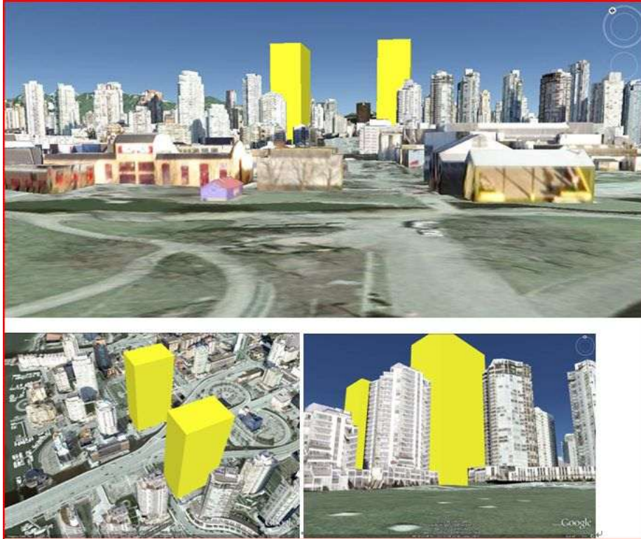
Figure 91 : Modélisation tridimensionnelle du volume constructible d'un terrain autorisé par la réglementation mise en débat (Bohus, 2010)
