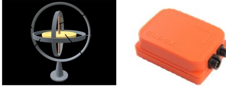
**Figure 3.23** : Mécanisme interne d'un gyroscope (gauche) et le senseur inertiel MTx de XSens (droite)
