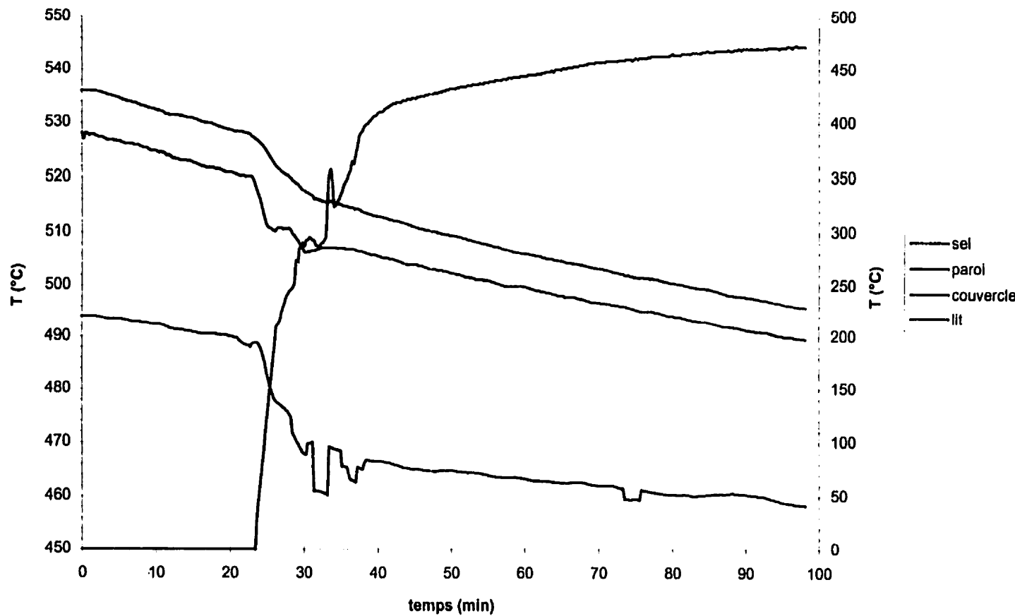
Figure B-1 Profils des températures mesurées dans le réacteur: pyrolyse pseudo-statique L11; t_{mix} = 22.5 s.
