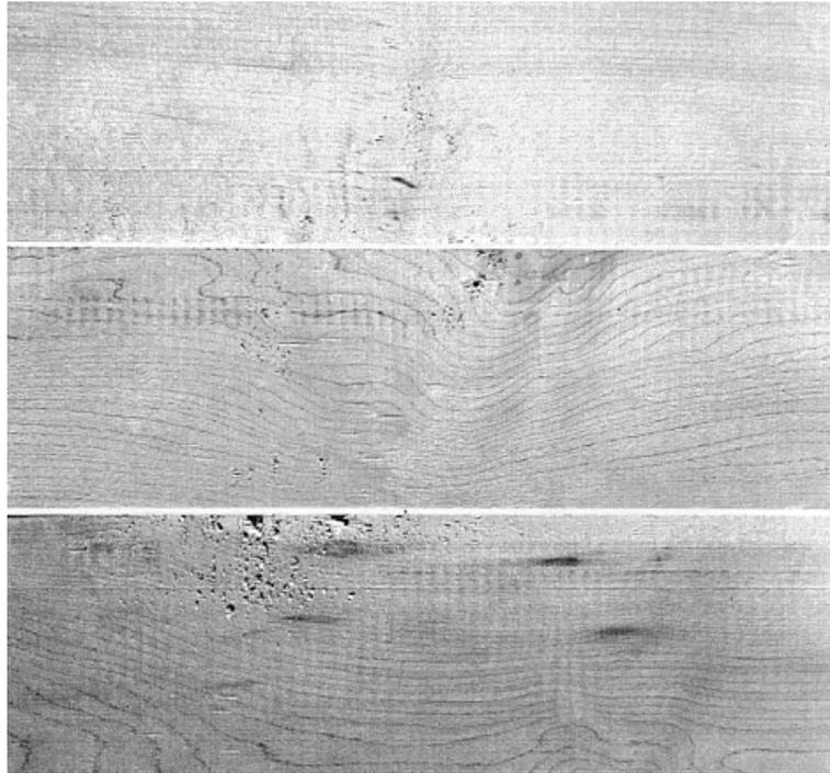
**Figure 1–14.** Divers niveaux de fil arraché à la surface de l'érable à sucre (tirée de ASTM D 1666 1987)
