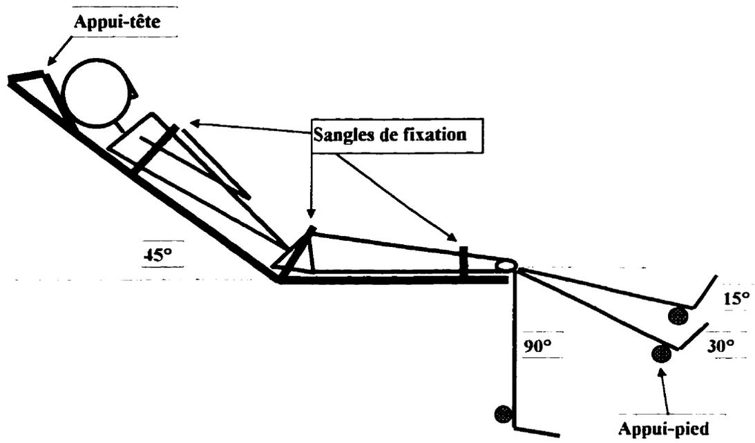
**Figure 3.15** Position typique d'un sujet sur le dynamomètre KinCom avec la hanche à  $45^\circ$  de flexion et le genou à  $90^\circ$ ,  $30^\circ$  et  $15^\circ$  de flexion.
