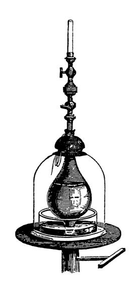
Figure 1. The apparatus of Gustav H. Magnus for determination of blood gasses. From G. H. Magnus, "Über die im Blute enthaltenen Gase, Sauerstoff, Stickstoff und Kohlensäure" (1837) p. 594. For description see p. 68 opposite
